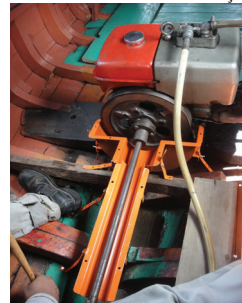
Fotografia 12: Parte inferior da cobertura protetora de eixo de embarcação
