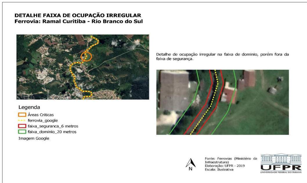
Figura 8 – Detalhe 1 de ocupação na faixa de domínio
